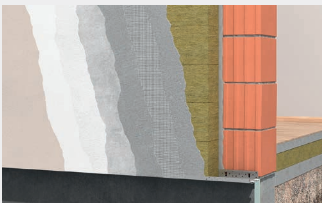
Malowanie farbą elewacyjną.
